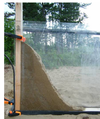
図 4 細砂の安息角に及ぼす湿り気の効果を示す実験
